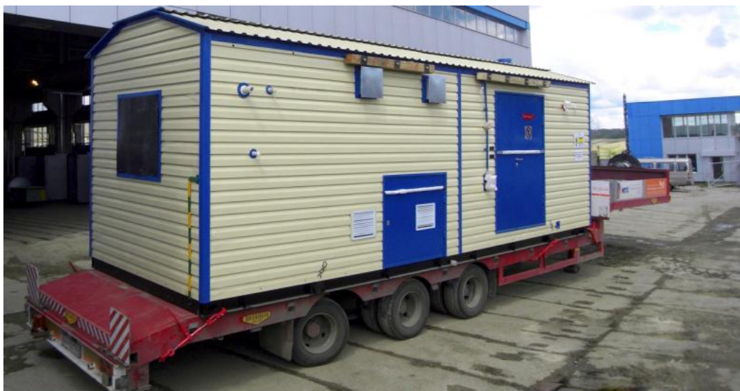
Блочная котельная установка БКУ
